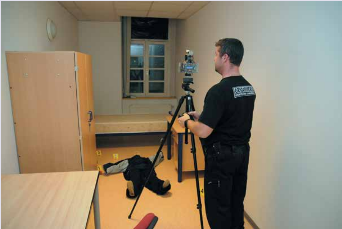
Prise de mesures avec Robo'Tic à l'aide d'une manette.
