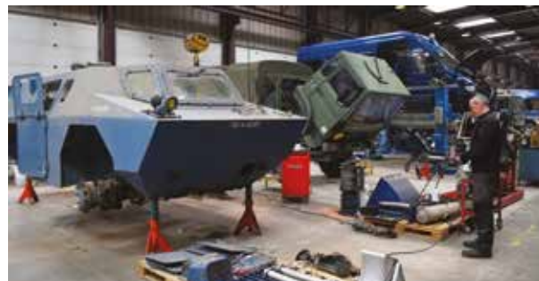
Remise à niveau de VBRG au CSAG SATORY par « canibalisation » des pièces sur les engins réformés.
